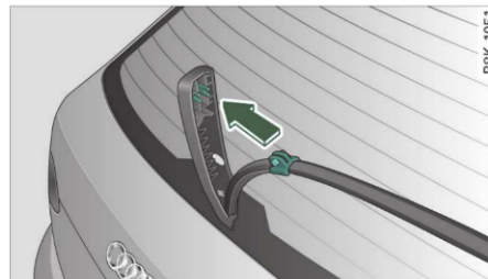
Fig. 55 Ștergătorul de lunetă: Fixarea lamelei ștergătorului
