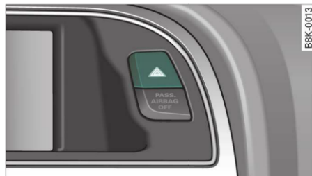
Fig. 44 Postul de conducere: Comutator pentru luminile de avarie
