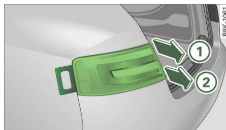
Fig. 274 Demontarea lămpilor din lateral spate
