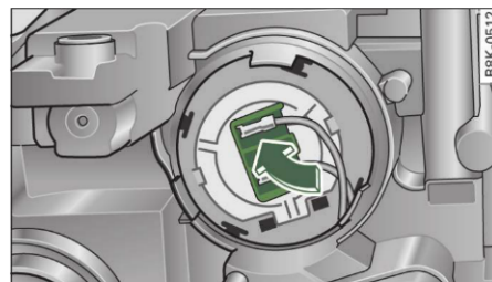
Fig. 264 Introducerea becului luminii de drum
