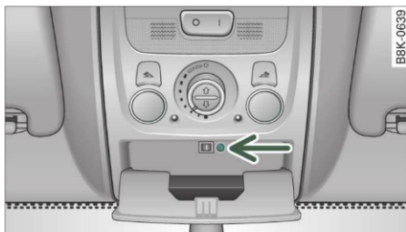
Fig. 37 Plafonul: Deșurubarea lămpii
