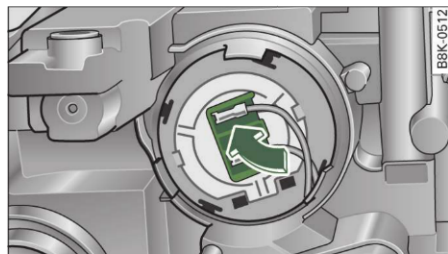
Fig. 268 Introducerea becului luminii de întâlnire
