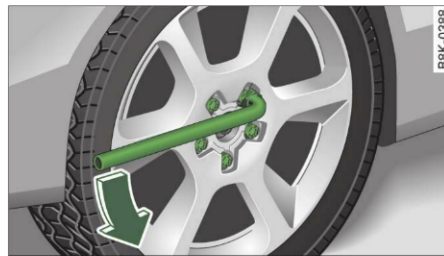
Fig. 243 Înlucuirea roții: Slăbirea șuruburilor roții
