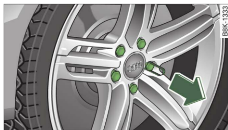
Fig. 242 Înlucuirea roții: Scoaterea capacelor
