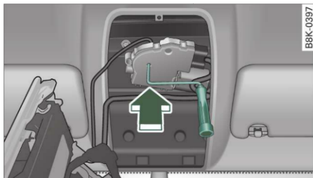
Fig. 38 Plafonul: Manivela pentru acționarea de urgență
