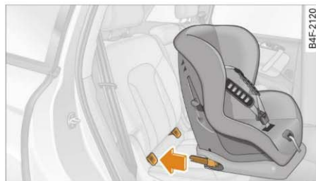
Fig. 197 Bancheta din spate: Fixarea scaunului pentru copii cu ISOFIX
