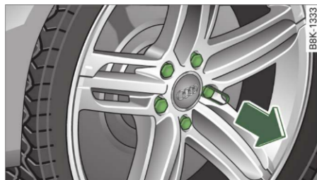
Fig. 242 Înlocuirea roții: Scoaterea capacelor
