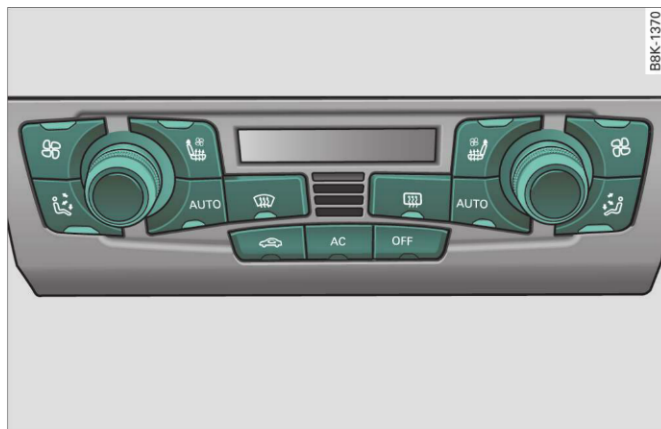
Fig. 90 Instalatie de climatizare automată confort 3 zone: Elementele de comandă
