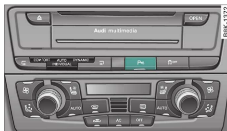
Fig. 156 Consola centrală: Tastă pentru asistența la parcare
