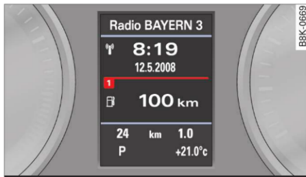
Fig. 7 Sistemul de informare a șoferului în tabloul de bord
