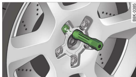
Fig. 246 Înlocuirea roții: Latura hexagonală pentru șuruburi
