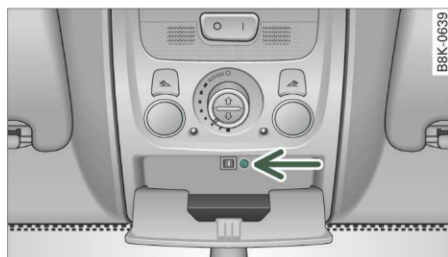
Fig. 37 Plafonul: Deșurubarea lămpii
