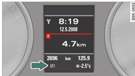
Fig. 144 Afișajul: Selectarea manuală a vitezelor (tiptronic)
