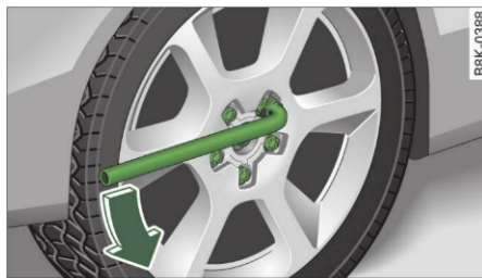
Fig. 243 Înlocuirea roții: Slăbirea șuruburilor roții
