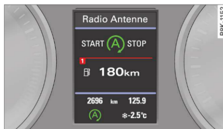
Fig. 98 Tabloul cu instrumente: Oprirea motorului (etapa Stop)
