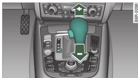
Fig. 151 Consola centrală: Selectare manuală (tiptronic)
