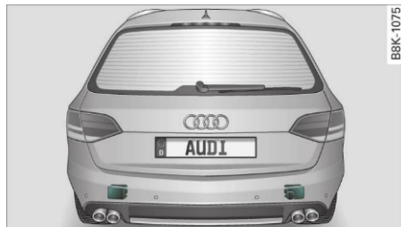
Fig. 128 Bara de protecție din spate: Poziția senzorilor radar (nu sunt vizibili din exterior)
