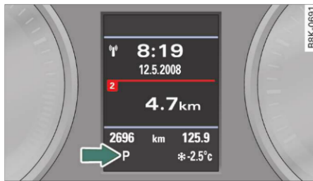
Fig. 140 Afișajul: Pozițiile selectorului de viteze
