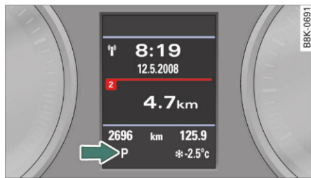
Fig. 148 Afîșajul: Pozițiile selectorului de viteze
