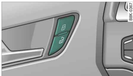
Fig. 27 Portiera șoferului: comutatorul închiderii centralizate
