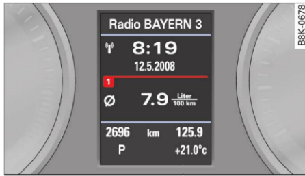
Fig. 10 Calculatorul de bord: Domeniul de memorare 1
