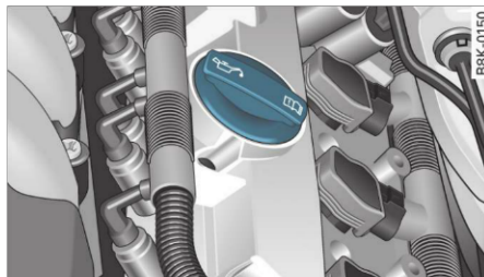
Fig. 224 Compartimentul motorului: Capacul orificiului de umplere cu ulei
