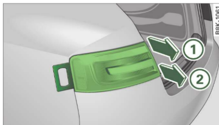
Fig. 274 Demontarea lămpilor din lateral spate
