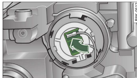
Fig. 264 Introducerea becului luminii de drum
