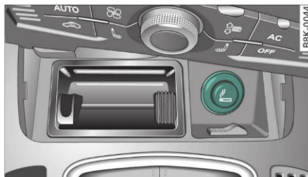
Fig. 65 Consola centrală din față: Bricheta
