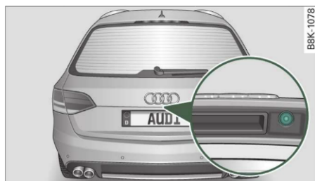
Fig. 161 Portbagajul: Locul de amplasare al camerei video
