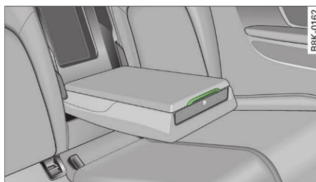
Fig. 235 Cotiera din mijloc a banchetei din spate: Trusa de prim-ajutor (cu trapă de încărcare)
