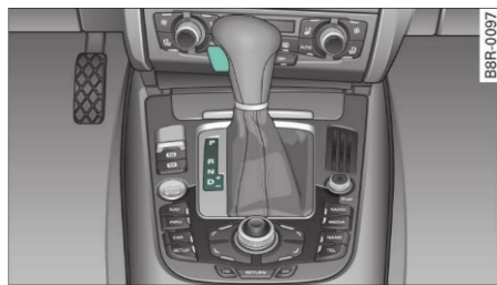
Fig. 150 Consola centrală: selectorul de viteze cu tastă de blocare
