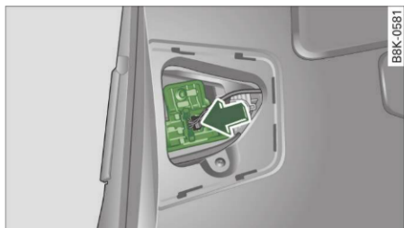
Fig. 280 Capacul portbagajului: Demontarea suportului lămpii
