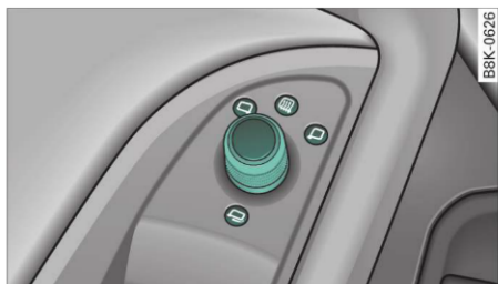
Fig. 48 Imagine din portiera șoferului: Butonul rotativ
