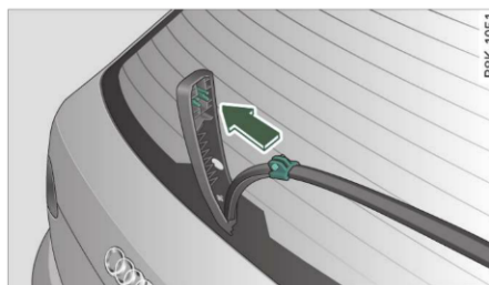
Fig. 55 Ștergătorul de lunetă: Fixarea lamelei ștergătorului
