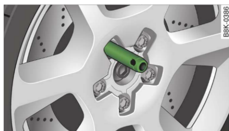
Fig. 247 Înlocuirea roții: Știftul de montaj în orificiul de sus
