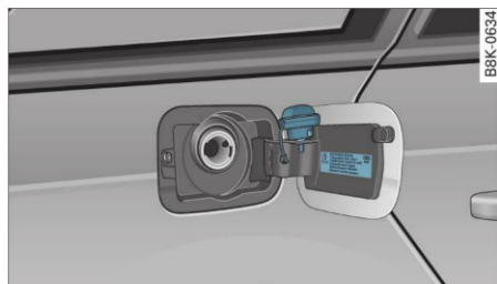
Fig. 215 Clapeta rezervorului cu capac prins
