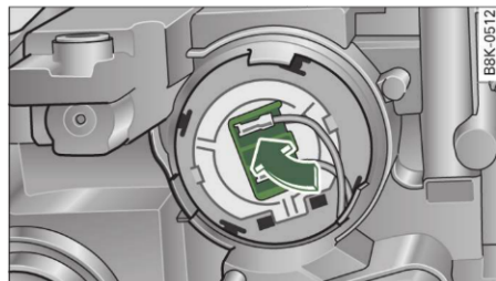
Fig. 268 Introducerea becului luminii de întâlnire
