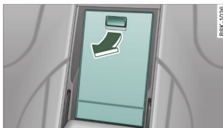
Fig. 234 Cotiera din mijloc a banchetei din spate: Trusa de prim-ajutor (fără trapă de încărcare)
