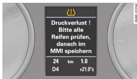
Fig. 232 Afișaj: Lampa de control de culoare roșie cu indicație
