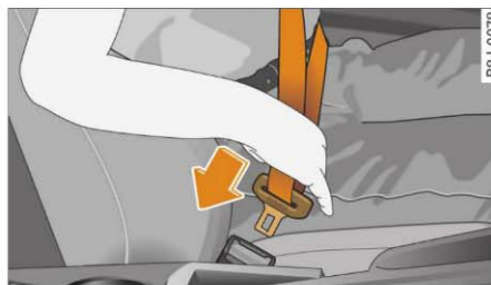
Fig. 178 Scaunul șoferului: Fanta de prindere și elementul de fixare a centurii
