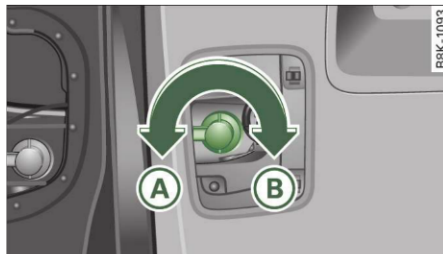
Fig. 258 Prezentarea în principiu: Soclul de lampă tip baionetă
