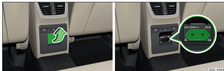
Fig. 98 Open the cover of the 230 volt outlet / 230 volt outlet
