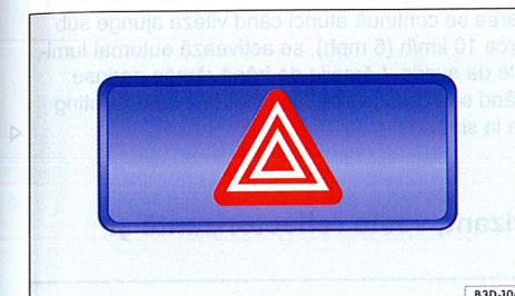
Fig. 211 În partea superioară a consolei centrale: comutatorul pentru luminile de avarie.
