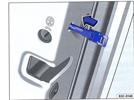
Fig. 215 Încuierea în caz de urgență a autovehiculului cu ajutorul cheii de urgență.
