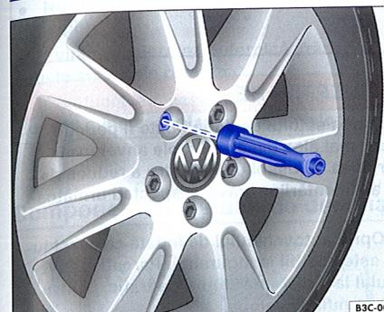
**Fig. 236** Înlocuirea roții: deșurubați șuruburile de roți cu șurubelnita.
