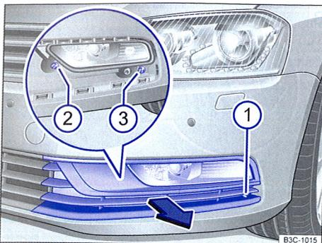
Fig. 244 În bara de protecție stânga-față: proiecto- rul pentru lumina de ceată, lumina de zi și farurile adaptive.
