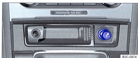
Fig. 130 În consola centrală față: brichetă în scumieră.
