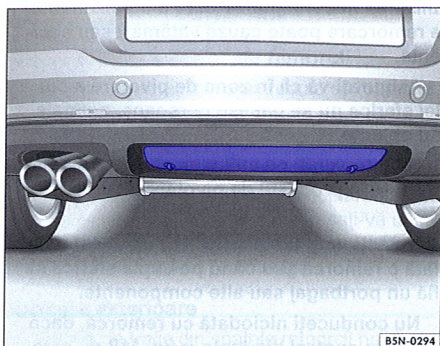
Fig. 113 Bara de protecție spate: detașarea capului.
