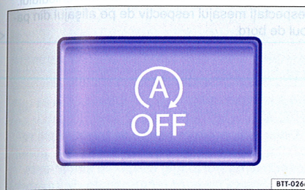
Fig. 152 În consola centrală: Tasta pentru sistemul Start-Stop.
