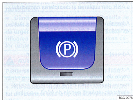
Fig. 147 În partea de jos a consolei centrale: tasta pentru frâna de parcare acționată electronic.
