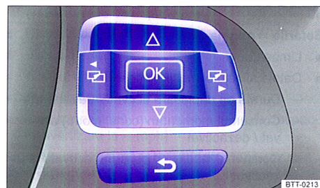
Fig. 15 Partea dreaptă a volanului multifuncțional: tastele pentru acționarea meniurilor din panoul de bord.
