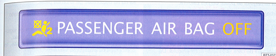
Fig. 70 Lampă de control din planșa de bord pentru airbagul dezactivat al pasagerului față.
