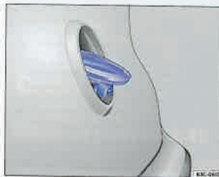
Fig. 13 În hayon: Amplasarea camerei video pentru marșarier.
