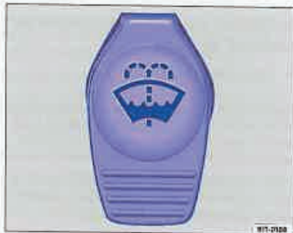
Fig. 10 În compartimentul motorului: Capacul albăstru al rezervorului pentru lichidul de spălat parbrizul.
