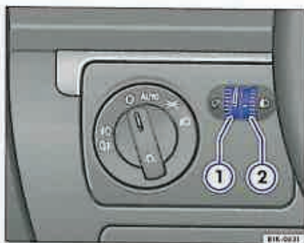
Fig. 39 Imagine din tabloul de bord: Regulator pentru iluminarea instrumentelor / comutatoarelor (1) și reglarea farurilor (2).
