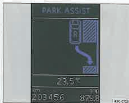
Fig. 22 Pe display-ul din tabloul de instrumente: Spațiu de parcare recunoscut cu indicația (R în autovehicul) de a selecta treapta de marșarier.
