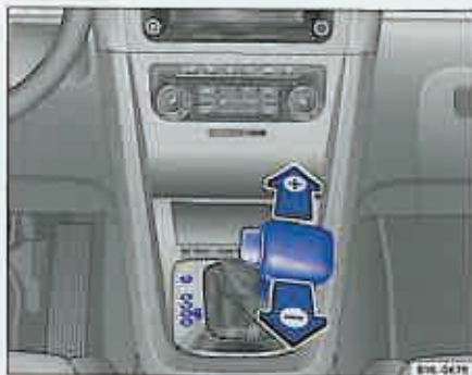
Fig. 7 Imagine din consola centrală: Selectorul de viteze în poziția tiptronic (cutia de viteze cu ambreiaj dublu DSG).
