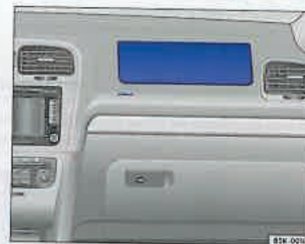
Fig. 23 Locul de amplasare al airbag-ului frontal al pasagerului din dreapta în tabloul de bord.
