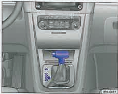
Fig. 6 Imagine din consola centrală: Selectorul de viteze al cutiei automate / cu ambreiaj dublu DSG.
