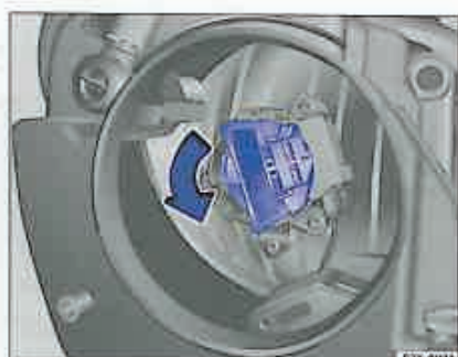
Fig. 47 Demontarea și montarea becului luminii de întâlnire.
