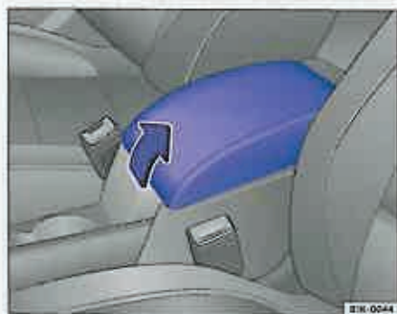
Fig. 81 Cotiera față cu spațiu de depozitare.
