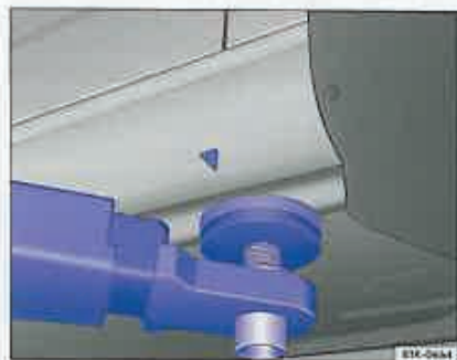
Fig. 66 Ridicarea cu ajutorul elevatorului: Punctele de sprijin din față.
