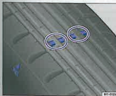
Fig. 19 Profilul pneurilor: Indicatorul de uzură.
