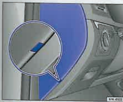
Fig. 41 În partea stângă a tabloului de instrumente: Capacul cutiei de siguranțe.
