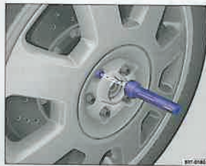
Fig. 34 Înlocuirea roții: Deșurubați prezoanele de roată cu șurubelnița.
