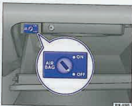
Fig. 33 Torpedoul de pe partea pasagerului din dreapta: Întrerupător cu cheie pentru dezactivarea și activarea airbag-ului frontal al pasagerului din dreapta.
