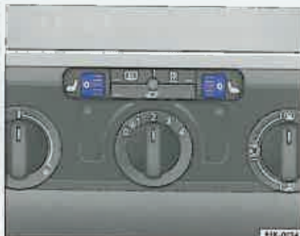
Fig. 66 Autovehicule cu instalație de încălzire: Regulator pentru încălzirea scaunelor din față.
