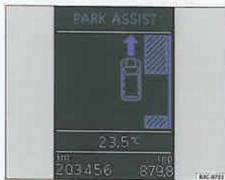
Fig. 21 Pe display-ul din tabloul de instrumente: Spațiu de parcare recunoscut cu indicația (săgeata) de a continua deplasarea.
