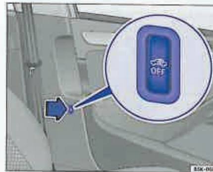
Fig. 27 Supravegherea interioară: Tasta pentru decuplarea instalației de supraveghere și a protecției la remorcare.
