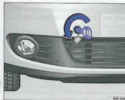
Fig. 64 În bara de protecție dreapta față: Înșurubarea inelului de remorcăre.
