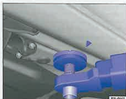
Fig. 67 Ridicarea cu ajutorul elevatorului: Punctele de sprijin din spate.
