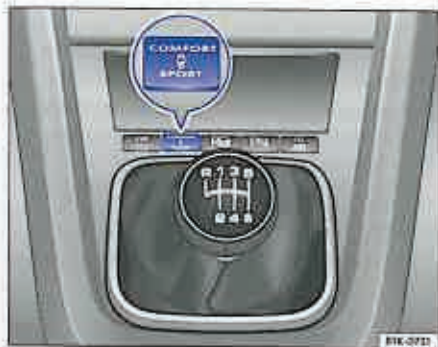
Fig. 44 În consola centrală: Tastă pentru reglarea adaptată a trenului de rulare.
