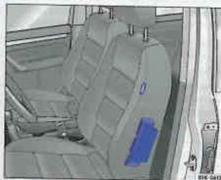
Fig. 29 Imagine de referință: amplasarea airbag-ului lateral în scaunul stânga față.
