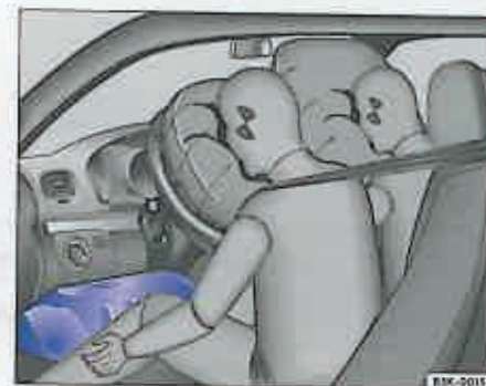
Fig. 28 Imagine de referință: Airbag pentru genunchi declanșat
