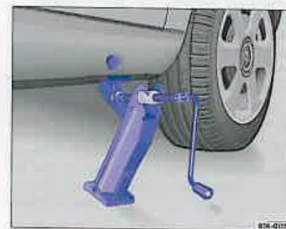
Fig. 33 Amplasarea cricului în spate pe partea stângă.
