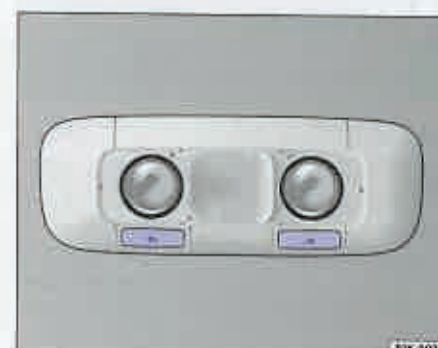
Fig. 46 Plafonul: Luminile interioare și lămpile pentru citit din spate.
