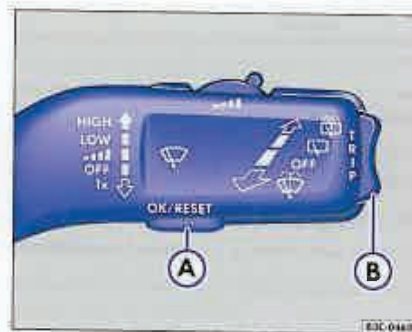
Fig. 12 În maneta de acționare a ștergătoarelor: Tasta pentru confirmarea punctelor din meniu și butonul basculant pentru schimbarea meniurilor.
