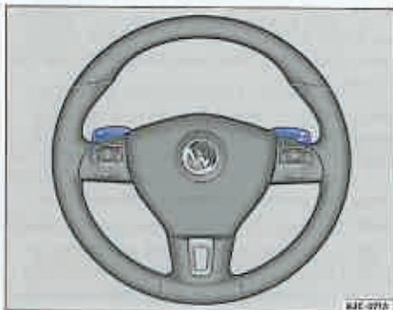
Fig. 8 Volanul multifuncțional cu taste pentru cutia de viteze automată / cu ambreiaj dublu DSG.
