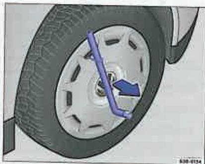
Fig. 29 Scoaterea capacului de roată.
