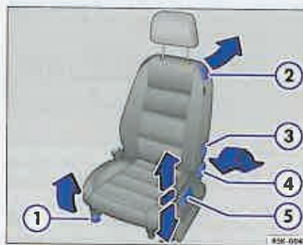
Fig. 61 Elementele de comandă pentru scaunul stânga față.
