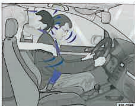
Fig. 13 Imagine de referință: Pasagerul din spate neasigurat este proiectat în față peste conducătorul care poartă centura de siguranță în mod regulat.
