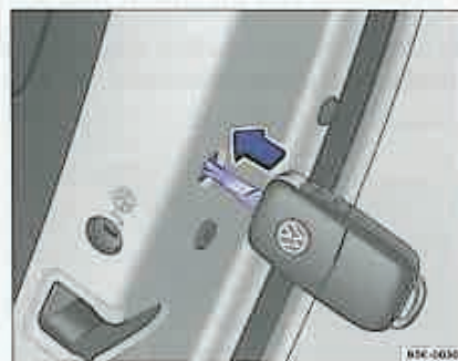
Fig. 37 Încuierea de urgență a ușii cu cheia.
