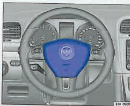
Fig. 22 Locul de amplasare al airbag-ului conducătorului în volan.
