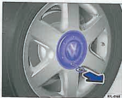
Fig. 26 Scoaterea capacului zonei centrale a roții.
