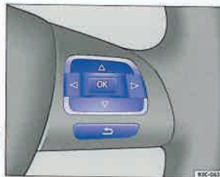
Fig. 13 Volanul multifuncțional: Partea dreaptă.
