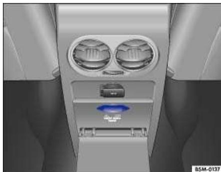
**Fig. 90** Rear center console: 115 volt socket.
