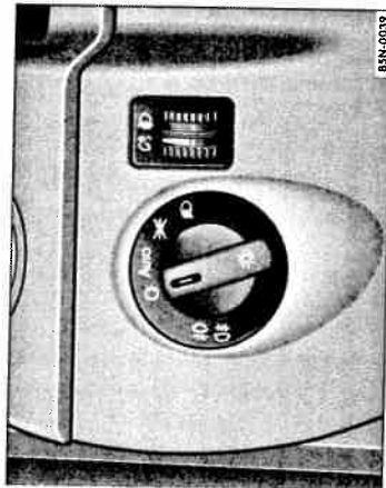
Fig. 39 Imagine din tabloul de bord: Înterupătorul pentru lumini, acționarea automată a luminilor, proiectoarele de ceață și luminile de ceață spate.
