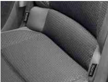
I sedili esterni in seconda fila sono corredati di occhielli ISOFIX, saldamente ancorati alla carrozzeria, per il fissaggio semplice e sicuro dei seggiolini per bambini.
