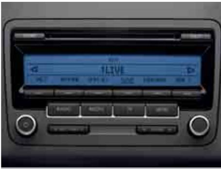
La **radio RCD 310** dispone di lettore CD, otto altoparlanti e presa multimediale AUX-IN. Può riprodurre file nel formato Mp3 o WMA e possiede una potenza in uscita di 4 x 20 Watt.
