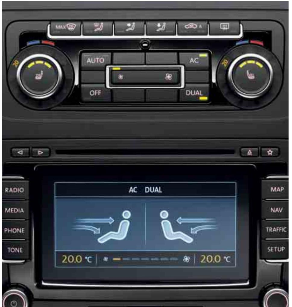
L'impianto di climatizzazione Climatronic regola la temperatura elettronicamente e suddivide l'abitacolo in zone climatiche differenti per il lato conducente ed il lato passeggero anteriore. La temperatura viene indicata su un display con la precisione di un grado. Un sensore della qualità dell'aria controlla l'aria all'esterno, attivando all'occorrenza autonomamente il dispositivo di ricircolo.
