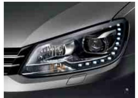
I **proiettori Bi-Xeno** dispongono di luce dinamica in curva. I fari si muovono seguendo automaticamente l'angolo di sterzata del veicolo, migliorando così l'illuminazione della carreggiata durante le curve. Grazie alla luce diurna a LED forniscono inoltre un'immagine estremamente sofisticata.
