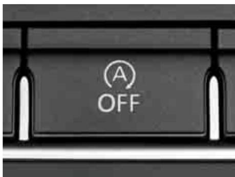
Il sistema Start/Stop permette una guida all'insegna dell'economia e della tutela dell'ambiente. Fermandosi in coda o davanti ad un semaforo rosso, il motore si spegne alla messa in folle. Per proseguire basta semplicemente innestare nuovamente la marcia.
