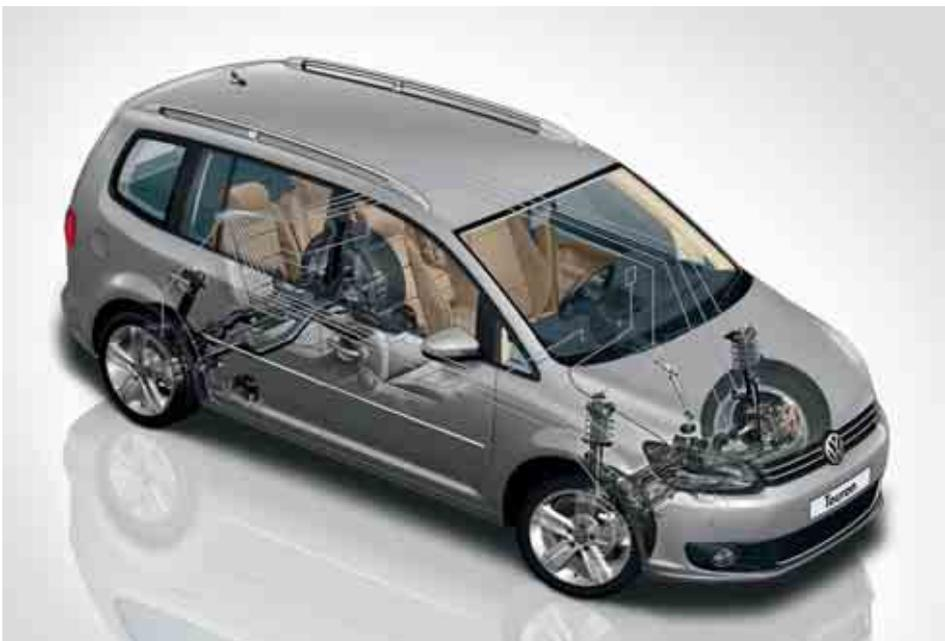
Il sistema di regolazione adattiva dell’assetto **DCC** adegua ogni ammortizzatore al manto stradale ed alle condizioni di guida. Premendo un tasto puoi optare per l’impostazione più rigida (o più confortevole) dell’assetto ribassato di 10 mm.
