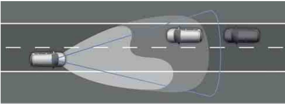
Tramite una videocamera installata dietro il parabrezza il sistema **Light Assist** individua le vetture che provengono dalla corsia opposta e provvede automaticamente, a seconda della velocità con cui stai viaggiando, a commutare i fari da luce abbagliante ad anabbagliante (e viceversa), offrendo maggiore comfort e sicurezza nei viaggi notturni. Il sistema interviene non appena avvista il veicolo che si sta avvicinando e riattiva la luce abbagliante solo quando tale veicolo è passato.
