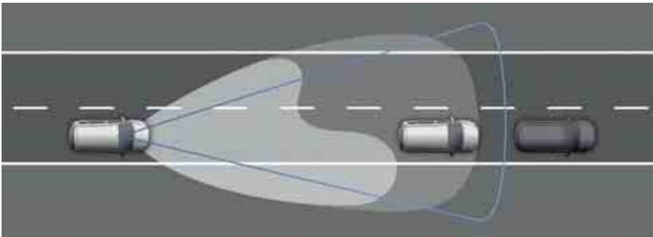
Allo stesso modo il **Light Assist** provvede a disattivare la luce abbagliante quando ti avvicini alla vettura che ti precede. Non appena la zona davanti a te risulta libera la luce abbagliante viene automaticamente riattivata. Il sistema permette un uso più mirato dei fari abbaglianti, evita di recare disturbo agli altri utenti del traffico e rende la guida molto più confortevole.
