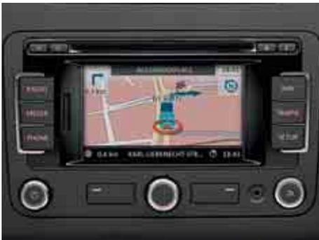
Il sistema di **radio-navigazione RNS 315** con lettore CD (riproduce file Mp3 e WMA) è dotato di un display a colori da 5" touchscreen e di uno slot per schede SD. Le mappe dell'Europa Occidentale sono pre-caricate nella memoria del sistema.
