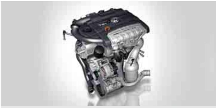
I **motori TSI** si caratterizzano per la combinazione tra iniezione diretta e tecnologia **Twincharger**. Tale combinazione genera motori particolarmente efficienti, in grado di coniugare rapporti di coppia elevati ad un consumo contenuto.
