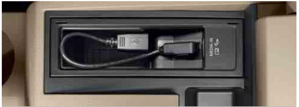
La **presa multimediale MEDIA-IN** con interfaccia USB o per iPod®/iPhone® consente il collegamento a fonti audio esterne ed il loro comando tramite la radio o il sistema di navigazione.
