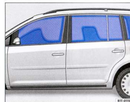
Fig. 32 Imagine de referință: Airbag cortină - declanșat.
