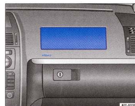
Fig. 25 Locul de amplasare al airbag-ului frontal al pasagerului din dreapta: în tabloul de bord.
