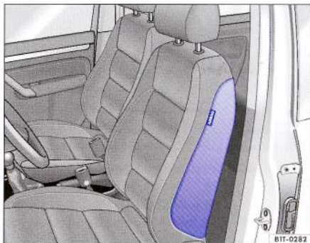
Fig. 29 Imagine de referință: amplasarea airbag-ului lateral în scaunul stânga față.
