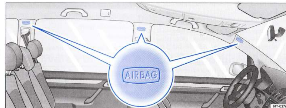
Fig. 31 Imagine de referință: Locul de amplasare al airbag-urilor cortină pe partea stângă a autovehiculului
