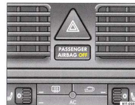
Fig. 34 Lampă de control în tabloul de instrumente pentru dezactivarea airbag-ului pasagerului din dreapta.
