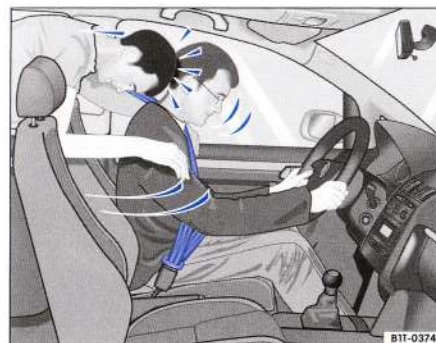
Fig. 12 Pasagerii din spate care nu folosesc centura de siguranță sunt proiectați în față, asupra conducătorului care folosește regulamente centura de siguranță.
