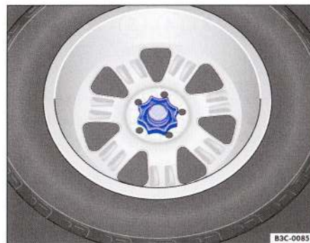
Fig. 30 În portbagaj: Rotiță pentru fixarea roții de rezervă.
