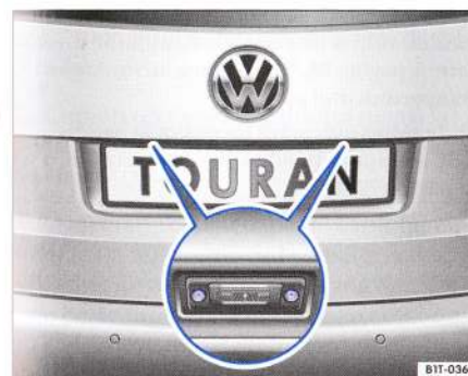
Fig. 57 În hayon: iluminarea nr. de înmatriculare.
