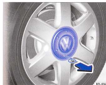
Fig. 33 Înlocuirea roții: Scoaterea capacului zonei centrale a roții.
