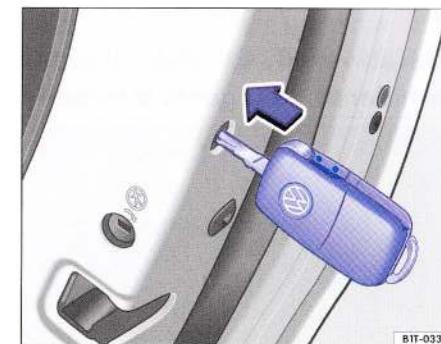
Fig. 42 Încuierea de urgență a autovehiculului cu telecomanda.
