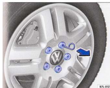
Fig. 34 Scoaterea capacelor prezoanelor de roată.
