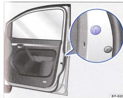
Fig. 41 Elementul închiderii de urgență, acoperit de garnitura de cauciuc, pe partea frontală a ușii pasagerului din dreapta.
