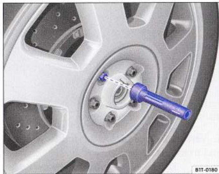
Fig. 40 Înlocuirea roții: Deșurubați prezoanele de roată cu șurubelnița.
