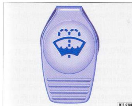
Fig. 17 În compartimentul motorului: Capacul albastru al rezervorului pentru lichidul de spălat parbrizul.
