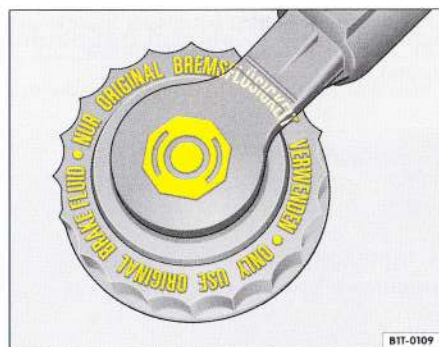
Fig. 21 În compartimentul motorului: Imagine de referință a capacului rezervorului lichidului de frână.
