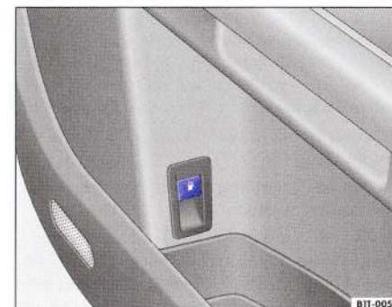
Fig. 8 Imagine din ușa conducătorului: Tasta de deblocare a clapetei rezervorului.
