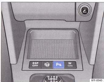
Fig. 127 Imagine din consola centrală: Tasta pentru conectarea sau deconectarea sistemului de control al distanței la parcare.
