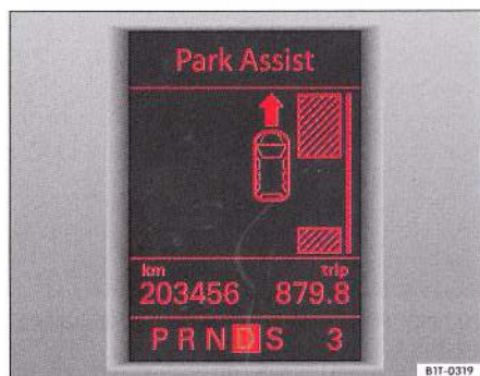
Fig. 131 Pe display-ul din tabloul de instrumente: Spațiu de parcare recunoscut cu indicația de a continua deplasarea.
