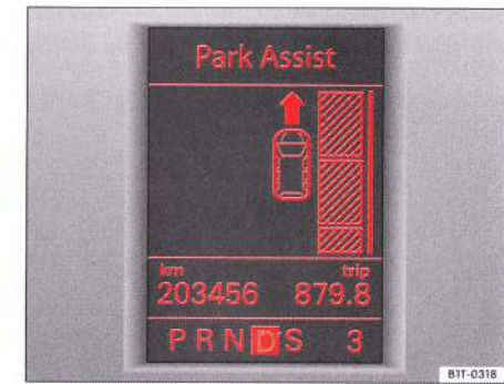
Fig. 130 Pe display-ul din tabloul de instrumente: Găsirea unui spațiu de parcare adecvat.
