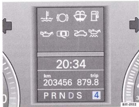
Fig. 123 Imagine din tabloul de bord: Afișarea poziției selectorului de viteze: poziția D și treapta de viteză 4.
