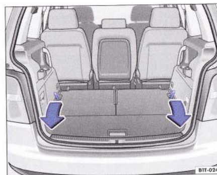
Fig. 71 Ridicarea spătarelor scaunelor celui de-al treilea rând de scaune.
