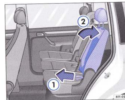
Fig. 60 Reglarea înclinării spătarelor scaunelor din al doilea rând.
