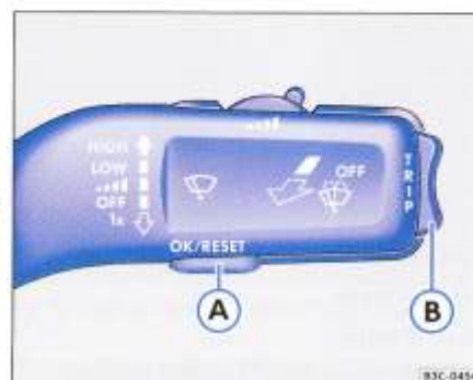
Fig. 11 În maneta de acționare a ștergătoarelor: Tasta A pentru confirmarea punctelor din meniu și butonul basculant B pentru schimbarea meniurilor.
