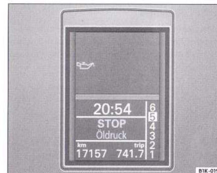
Fig. 9 Lampă de control și text de avertizare la autovehiculele cu zonă redusă de afișare pe display-ul din tabloul de instrumente: STOP presiune ulei.
