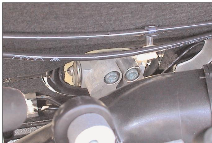
La valvola ad espansione polverizza il liquido criogeno in adduzione e ne regola il flusso in modo che il vapore diventi gassoso - a seconda della conduzione termica - soltanto in uscita dall'evaporatore.
