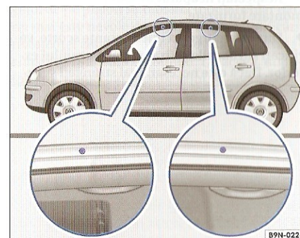
Fig. 69 Punctele de fixare la autovehiculele cu 4 uși.
