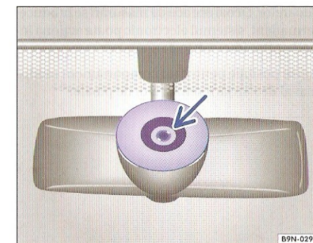
Fig. 37 Suprafața sensibilă a senzorului de ploaie.
