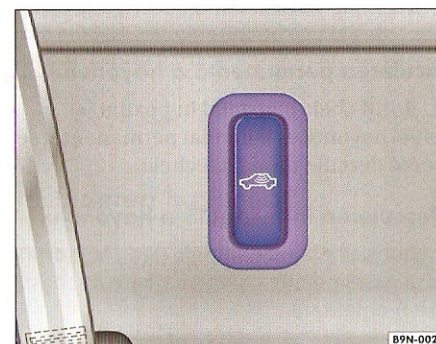
Fig. 20 Tasta pentru dezactivarea instalației de supraveghere interioară.
