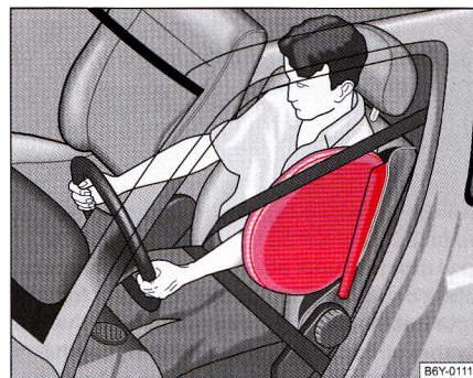
Fig. 166 Airbag-uri laterale umplute cu gaz
