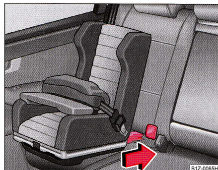
Fig. 179 Scaunul cu sistem ISOFIX se montează în dispozitive de prindere existente.
