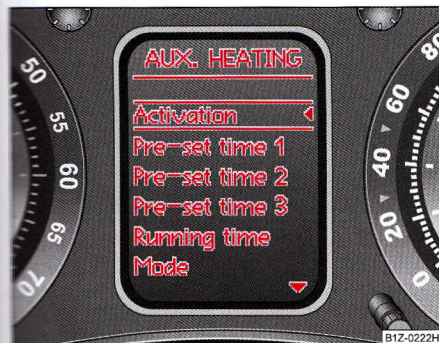
Fig. 125 Display informații: Aux. Heating (încălzirea în staționare)
