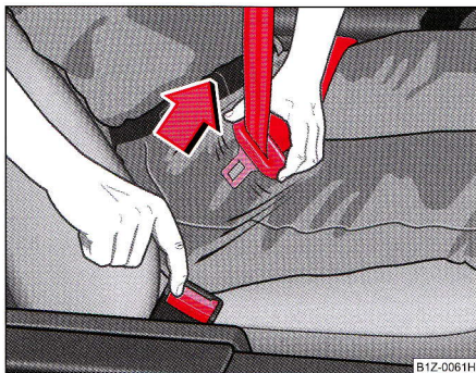
Fig. 160 Eliberarea elementului de prindere din dispozitiv
