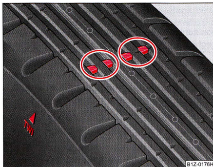
Fig. 200 Profilul pneului cu indicator de uzură
