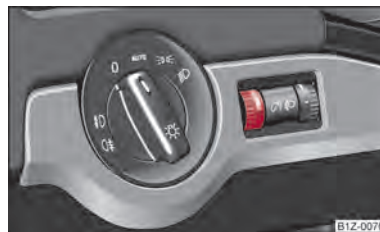
Fig. 27 Tabloul de bord: Iluminarea instrumentelor de bord
