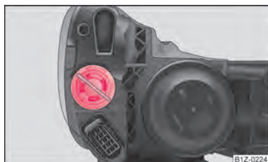
Fig. 182 Demontarea becului cu incandescență al luminii de semnalizare din față
