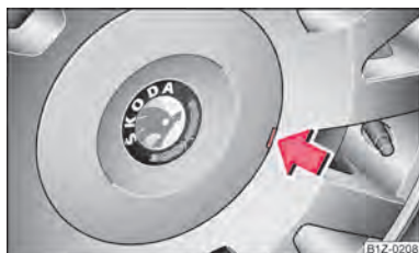
Fig. 165 Scoaterea ornamentului de roată la jantele din metal ușor
