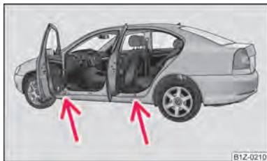
Fig. 167 Înlocuirea roții: Puncte pentru fixarea cricului
