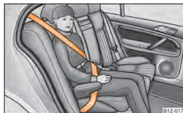
Fig. 135 Scaun pentru copii din grupa 3 montat pe scaunul din spate, cu fața la sensul de mers
