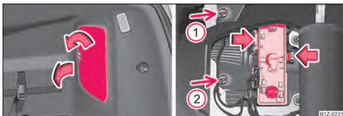
Fig. 189 Portbagajul: Capacul suportului becului / Demontarea suportului lămpii
