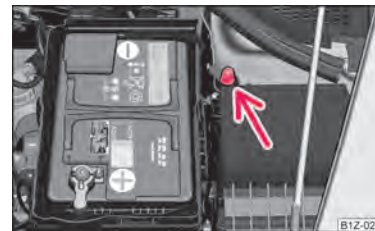
Fig. 172 Pornirea asistată la autovehiculele cu sistem START-STOPP
