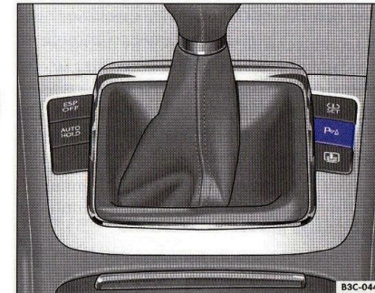
Fig. 15 Imagine din consola centrală: Tasta pentru conectarea sau deconectarea sistemului de control al distanței la parcare
