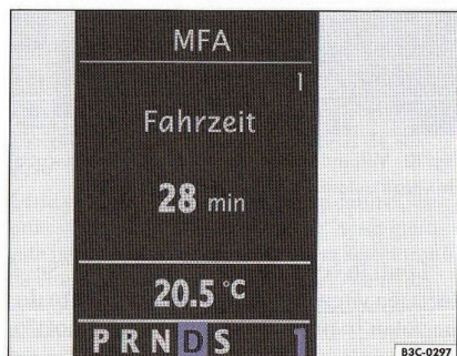
Fig. 11 Imagine din tabloul de bord: Afișarea poziției selectorului de viteze: poziția D și treapta de viteză 1.
