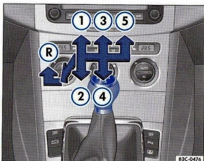
Fig. 4 Imagine din consola centrală: Schema de selectare a treptelor cutiei de viteze cu 5 trepte.
