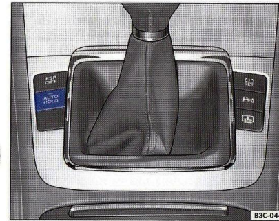
Fig. 14 Imagine din consola centrală: Tastă pentru Auto Hold
