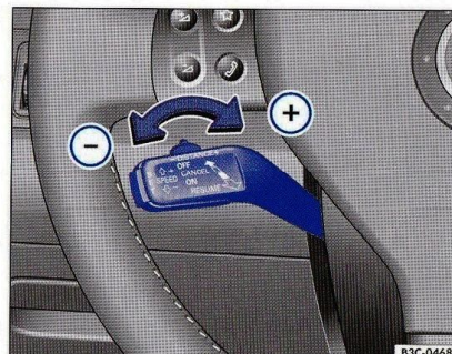
Fig. 23 Elemente de comandă ale sistemului de reglare automată a distanței: Reglarea distanței.
