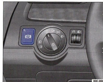
Fig. 13 Imagine din tabloul de bord: Tasta frânei electronice de parcare.
