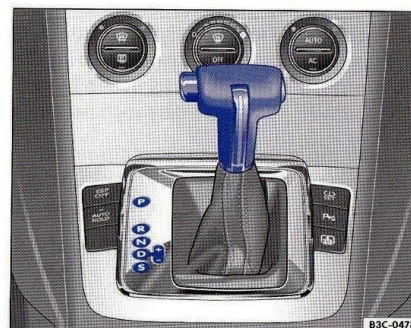
Fig. 6 Imagine din consola centrală: Selectorul de viteze al cutiei automate / cu cuplaj dublu DSG.
