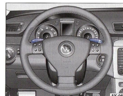
Fig. 10 Volanul multifuncțional cu taste pentru cutia de viteze automată / cu culaj dublu DSG.
