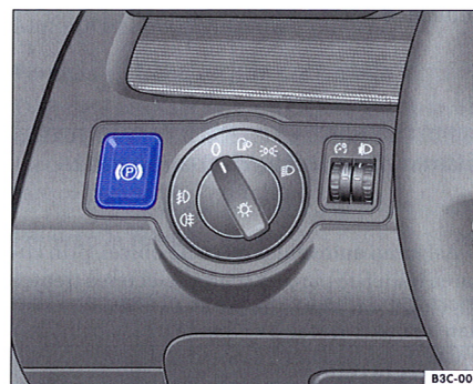
Fig. 123 Imagine din tabloul de bord: Tasta frânei electronice de parcare
