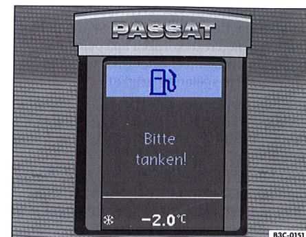
Fig. 10 Lampă de control și text de avertizare la autovehiculele cu zonă largă de afișare pe display-ul din tabloul de instrumente: Vă rugăm alimentați
