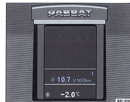
Fig. 15 Display-ul din tabloul de instrumente: Indicatorul multifuncțional și indicatorul temperaturii exterioare
