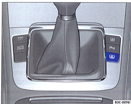
Fig. 50 Imagine din consola centrală: Comutator pentru ruloul parasolar al lunetei
