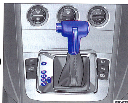
Fig. 116 Imagine din consola centrală: Maneta selectorului cutiei de viteze automate / directe
