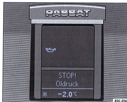
Fig. 9 Lampă de control și text de avertizare cu zonă redusă de afișare pe display-ul din tabloul de instrumente: STOP presiune ulei
