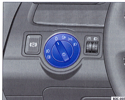
Fig. 40 Imagine din tabloul de bord: Înterupătorul pentru lumini, farurile de ceață și luminile de ceață spate
