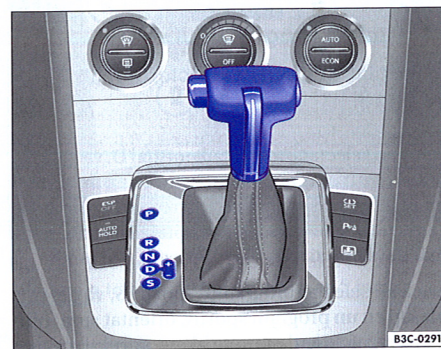
Fig. 118 Imagine din consola centrală: Maneta selectorului cutiei de viteze automate / directe
