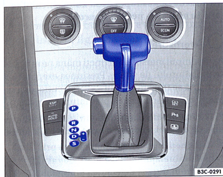
Fig. 117 Imagine din consola centrală: Maneta selectorului cutiei de viteze automate / directe
