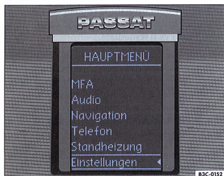
Fig. 11 Display-ul din tabloul de instrumente: Meniul principal (la acționarea de la maneta ștergătoarelor)
