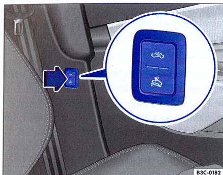
Fig. 30 Tasta pentru decuplarea instalației de supraveghere și a protecției la remorcare
