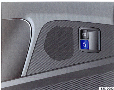
Fig. 33 Imagine din ușa conducătorului: Tasta pentru descuierea capacului portbagajului
