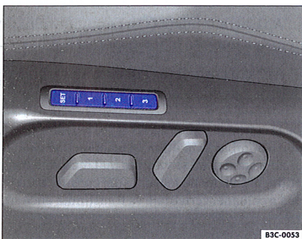
Fig. 64 Tastele Memory de la scaunul conducătorului: pentru memorare, tasta SET și apoi apăsați una din tastele Memory 1, 2 sau 3.
