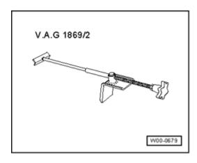
Brake pedal actuator V.A.G 1869/2
