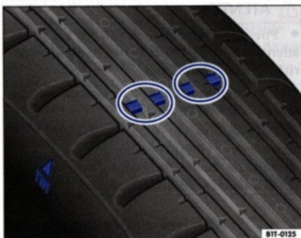
Fig. 16 Profilul pneurilor: Indicatorul de uzură
