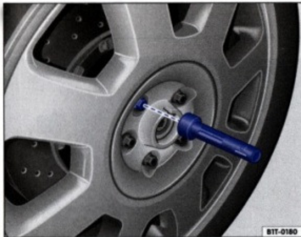
Fig. 27 Înlocuirea roții: Deșurubarea buloanelor de roată
