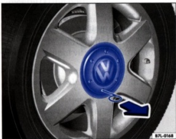
Fig. 21 Scoaterea capacului zonei centrale a roții
