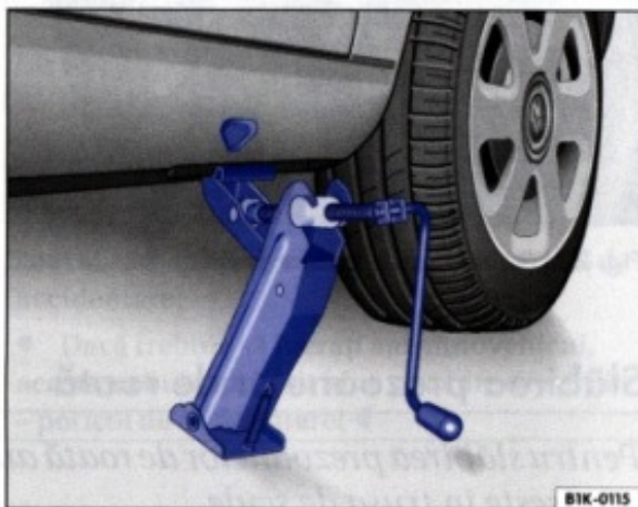
Fig. 26 Cric spate pe partea stângă
