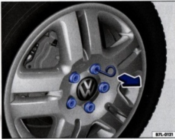
Fig. 22 Scoaterea capacelor prezoanelor de roată
