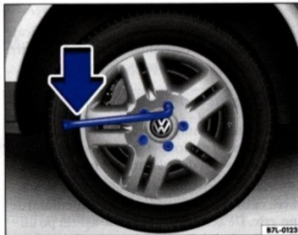
Fig. 23 Înlocuirea roții: Slăbirea șuruburilor de roată
