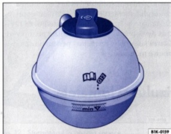
Fig. 9 În compartimentul motorului: Vas de expansiune lichid de răcire
