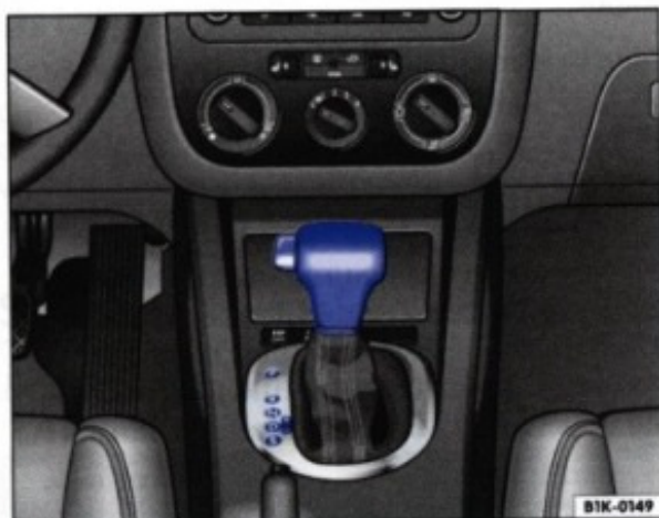
Fig. 101 Imagine din consola centrală: Selectorul pentru treptele de viteză (cutia de viteze automată / cutia de viteze directă)
