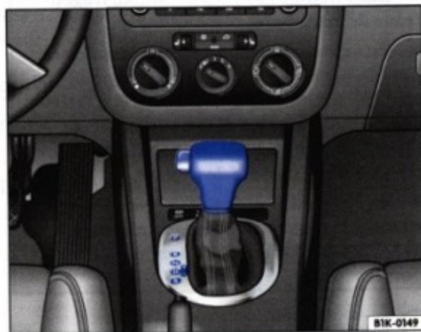
Fig. 102 Imagine din consola centrală: Selectorul pentru treptele de viteză (cutia de viteze automată / cutia de viteze directă)
