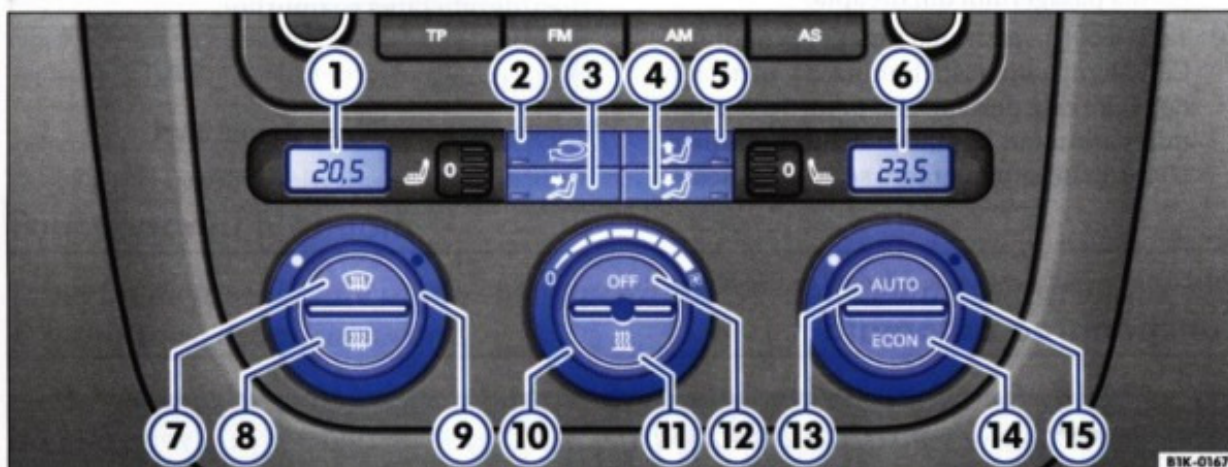
Fig. 90 În consola centrală: Elementele de comandă Climatronic
