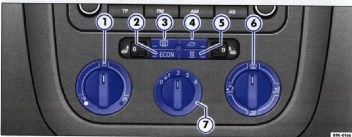
Fig. 89 În consola centrală: Elementele de comandă ale Climatic
