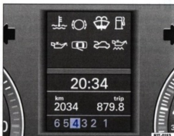
Fig. 105 Imagine din tabloul de instrumente: Afișarea treptei de viteză 4 selectată - tiptronic
