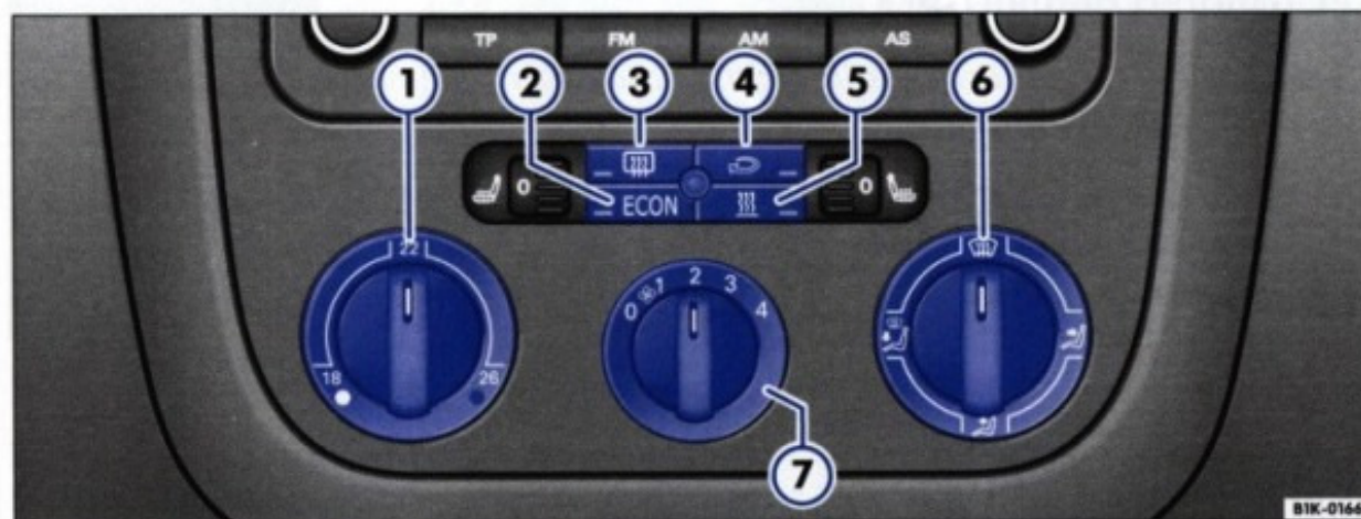
Fig. 88 În consola centrală: Elementele de comandă ale Climatic
