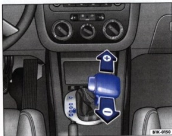
Fig. 103 Imagine din consola centrală: Cutia de viteze automată / cutia de viteze directă în poziția tiptronic
