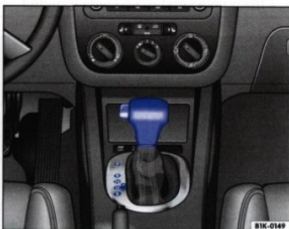
Fig. 100 Imagine din consola centrală: Selectorul pentru treptele de viteză (cutia de viteze automată / cutia de viteze directă)
