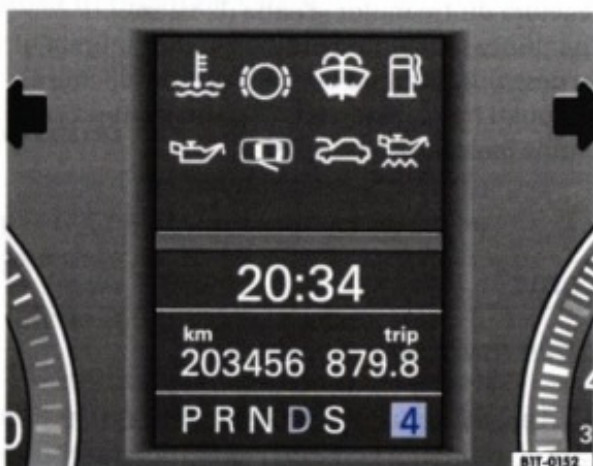
Fig. 104 Imagine din tabloul de instrumente: Afișarea poziției selectorului de viteze: poziția D și treapta de viteză 4
