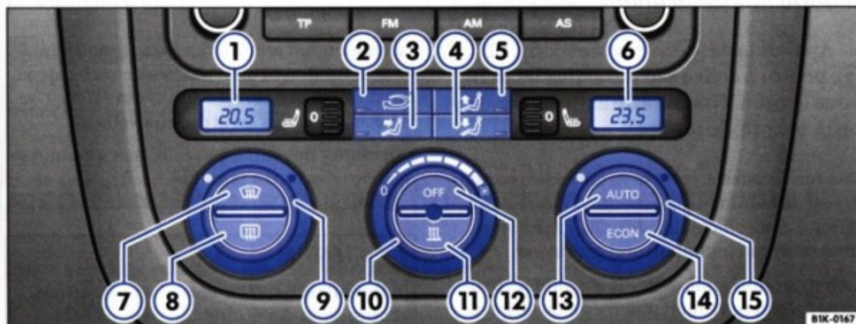
Fig. 92 În consola centrală: Elementele de comandă Climatronic
