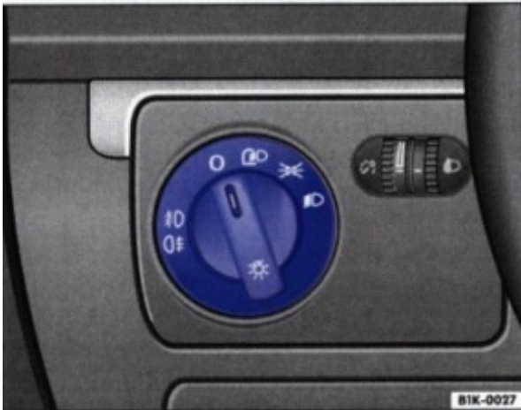
Fig. 37 Imagine din tabloul de bord: Întrerupătorul pentru lumini, farurile de ceață și luminile de ceață spate
