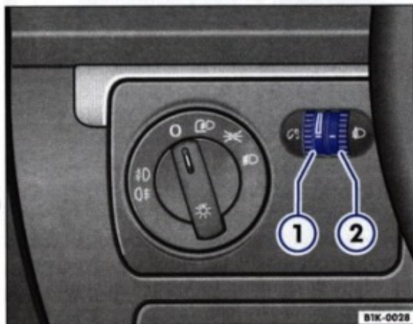
Fig. 38 Imagine din tabloul de bord: Regulator pentru iluminarea instrumentelor / comutatoarelor și reglarea farurilor
