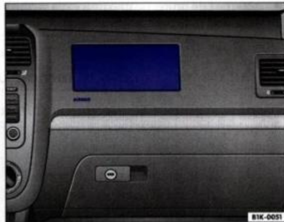
Fig. 17 Locul de amplasare al airbag-ului pasagerului din dreapta: în tabloul de bord
