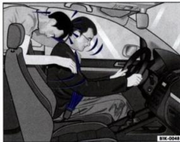
Fig. 8 Pasagerul din spate neasigurat este proiectat în față peste conducătorul care poartă centura de siguranță în mod regulamentar
