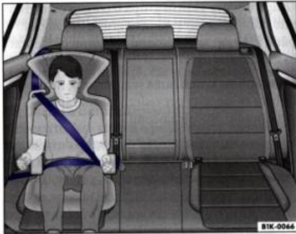
Fig. 29 Scaun pentru copii montat pe locul din spate cu fața la direcția de mers
