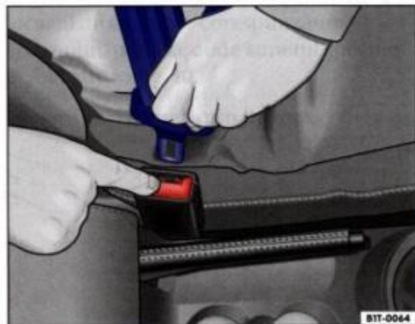
Fig. 14 Eliberarea elementului de prindere din dispozitiv
