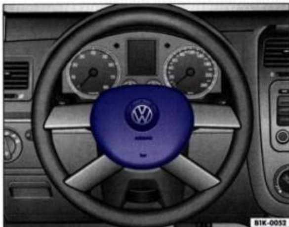
Fig. 16 Locul de amplasare al airbag-ului conducătorului: în volan
