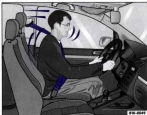
Fig. 9 Centura de siguranță corect utilizată îi oferă conducătorului autoturismului protecția necesară la executarea unei manevre bruște de frânare
