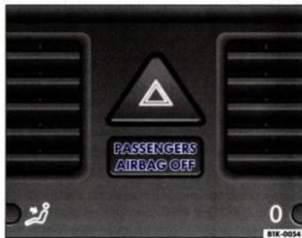
Fig. 26 Lampă de control pe tabloul de bord pentru airbag-ul pasagerului din dreapta
