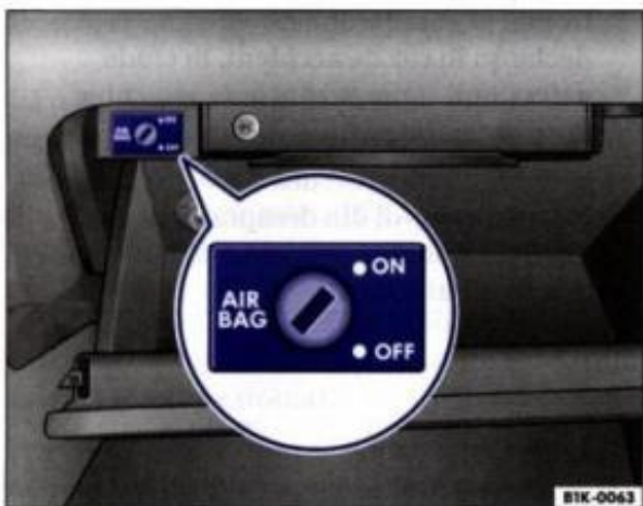
Fig. 25 În torpedou: Întrerupătorul cheie pentru activarea și dezactivarea airbag-ului frontal de pe partea pasagerului din dreapta
