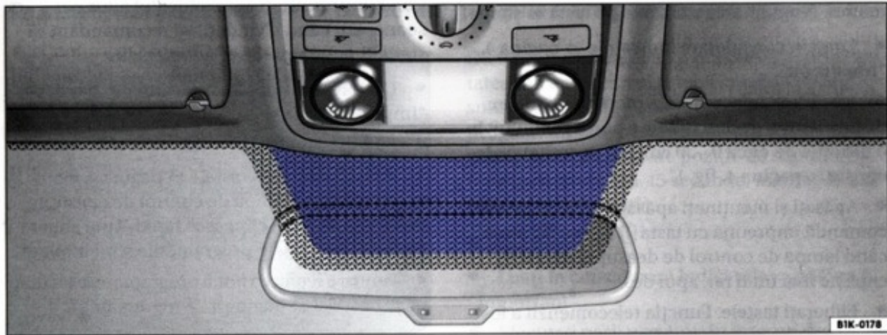
Fig. 2 Parbriz infraroșu cu folie metalică și cu fereastră de comunicație (zona albastră)
