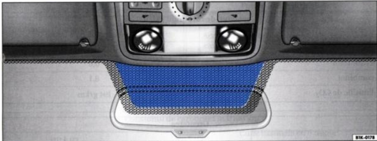
Fig. 1 Parbriz infraroșu cu folie metalică și cu fereastră de comunicație (zona albastră)
